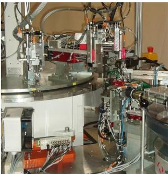
**Abb. 1 Pneumatik Rundtakt RGM mit 35 Takten pro Minute**
