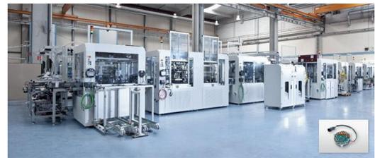
**Abb. 2 Vollautomatische Montageanlage mit WT-Transportsystem zur Montage von EC Motoren**
